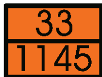
Figura 12 - Pannello di pericolo
